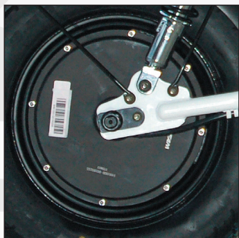
Skyteam e-ROCK -malleissa on nykyaikainen, harjaton napamoottori.
